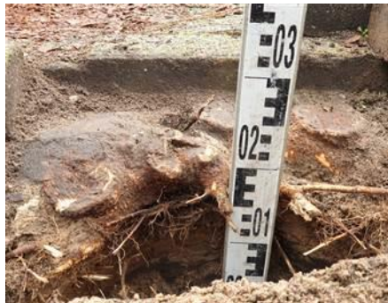
Afbeelding 12: zeer grove beworteling, direct onder de verharding (1)
