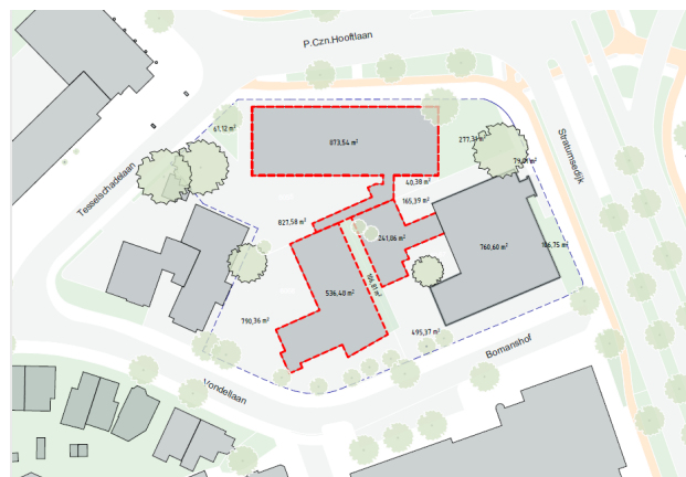
Impressie huidige situatie (in rood te slopen bebouwing)
