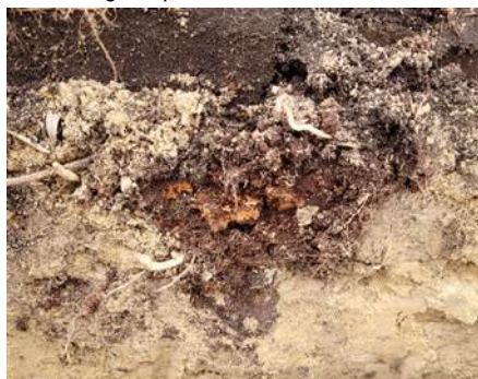
Afbeelding 15: afgestorven wortel \varnothing 9 cm op 13 cm-mv in profielkuil 4
