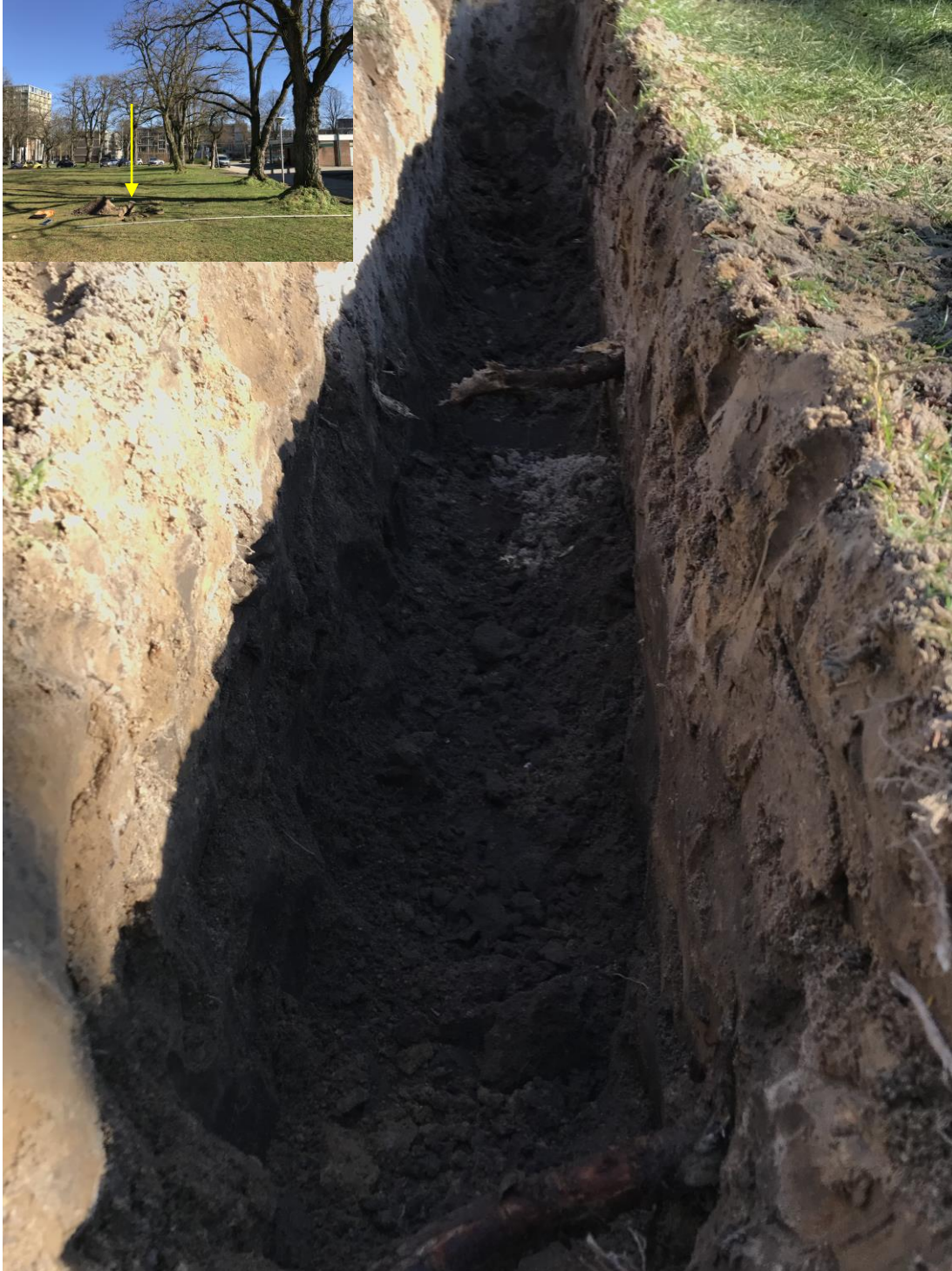
Figuur 7 Profielsleuf op de graafgrens van de toekomstige nieuwbouw, op een afstand van ca. 5,7 meter vanaf hart stamvoet van een valse acacia (nr. 14). Dit is tevens ongeveer de rand van de kroonprojectie aan deze zijde. Er is tot een diepte van 50 cm –mv extensieve opnamebeworteling waargenomen. Verder zijn er drie wortels met een diameter van ca. 2 cm aangetroffen. Verder zijn er een aantal dode wortels aangetroffen, tevens 2 cm. Er zijn geen stabiliteitswortels in de sleuf gevonden.
