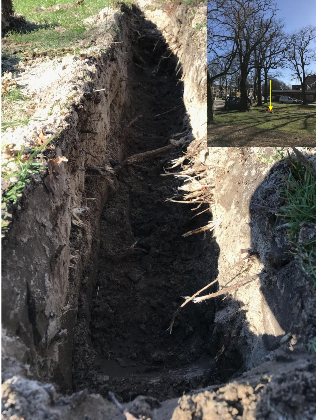
Figuur 8 Profielsleuf op voorgenomen grens van de parkeerplaats, op een afstand van ca. 3 meter vanaf hart stamvoet van een valse acacia (nr 12). Tot een diepte van 20 cm –mv is vrij intensieve opnamebworteling aangetroffen. Tussen een diepte van 00-40 cm –mv zijn meerdere wortels van ca. 2 cm diameter aangetroffen. Er zijn geen stabiliteitswortels aangetroffen.
