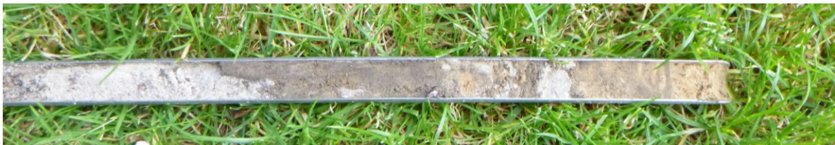
Figuur 3: Foto van boring 9 met links het opgebrachte zand en rechts het pakket zand dat bestaat uit brokken zand van uiteenlopend humusgehalte.
