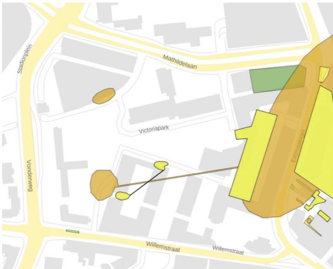
Afbeelding 16: Overzicht met in de kleur beige een ernstige waterbodemverontreiniging (VOC): aan de Gagelstraat (700 m 2 oppervlakte en 2.800 m 3 volume) en aan de Lichtstraat (550.000 m 3 volume). Daarnaast zijn er bodemverontreinigingen (grond) aangetroffen, aangegeven in de kleur geel. (bron: https://eindhoven.nazca4u.nl/atlas/ )
