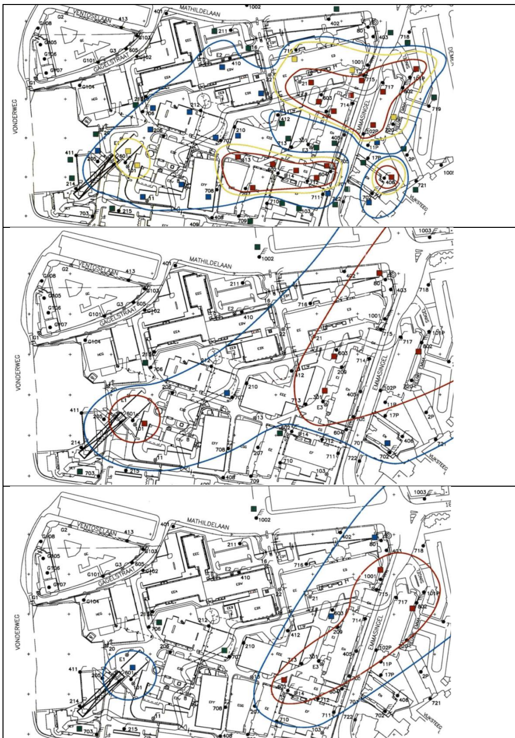
Afbeelding 2.5: benzeen verontreiniging Tot 9 m-mv (boven), tot 13,5 m-mv (midden) en tot 20 m-mv (onder) Overschrijding streefwaarde (blauw), matige verontreiniging (oranje) en sterke verontreiniging (rood)
