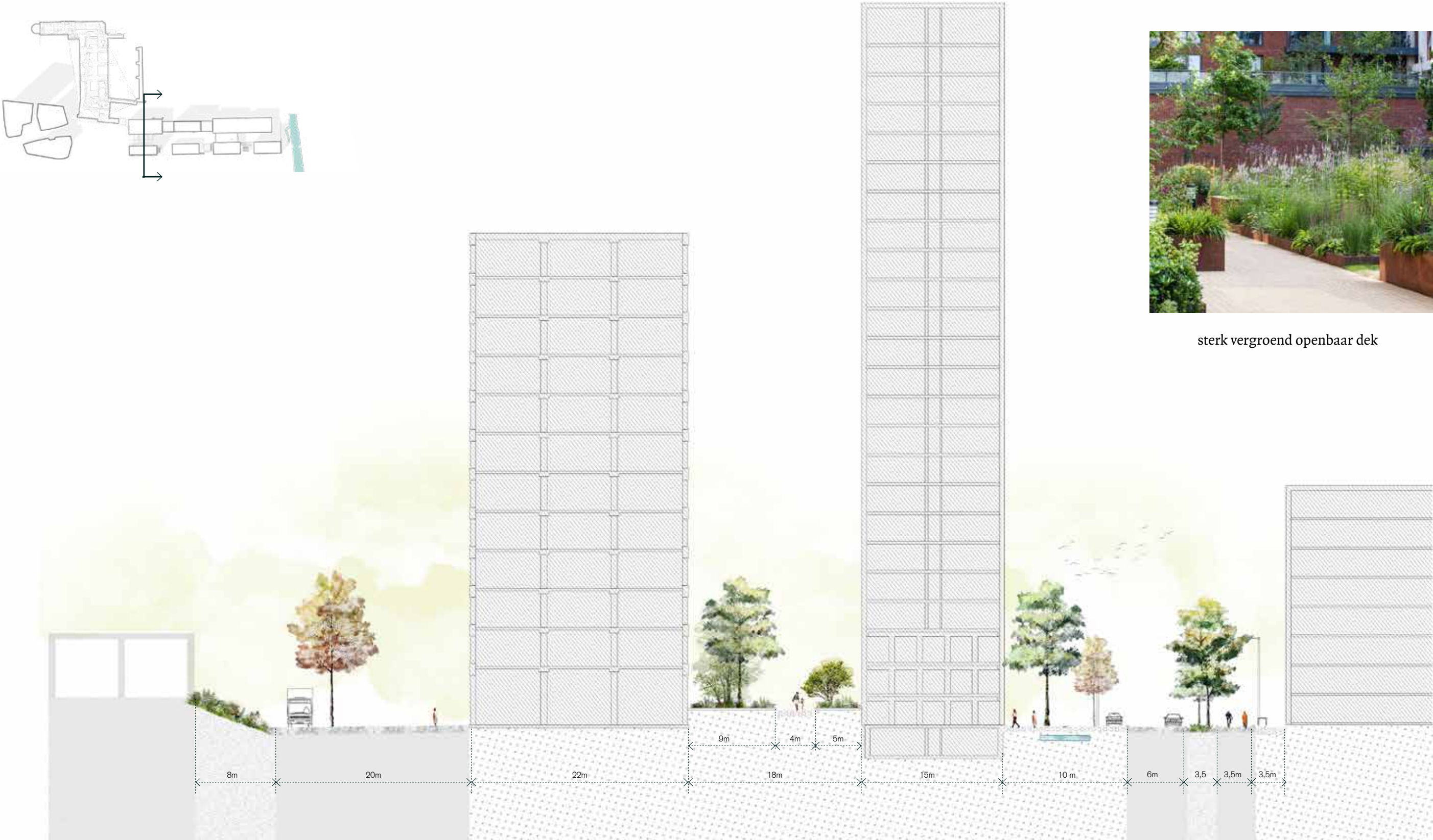
openbaar PARKdek en stadspromenade Stationsweg met ondergrondse Gender (principeprofiel fase 1)
