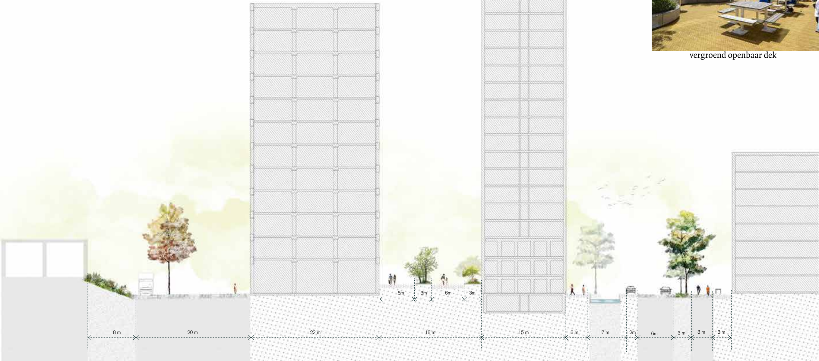
vergroend openbaar dek en Stationsweg met Genderafwisselend in breedte (principeprofiel fase 1)
