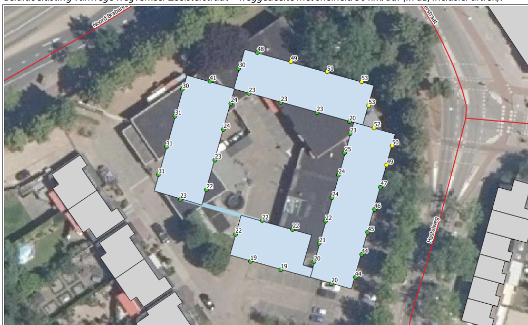
f4.3 Geluidbelasting vanwege wegverkeer Zeelsterstraat – weggedeelte met snelheid 50 km/uur (in dB, inclusief aftrek).
