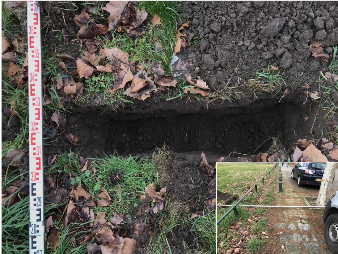
Figuur 9 Profielsleuf nabij oostelijke perceelgrens, op een afstand van 310 cm vanaf het hart van de stamvoet van de plataan. Tot een diepte van ca. 50 cm minus maaiveld zijn geen boomwortels aangetroffen. Inzet: zicht op profielsleuf ten opzichte van standplaats plataan.
