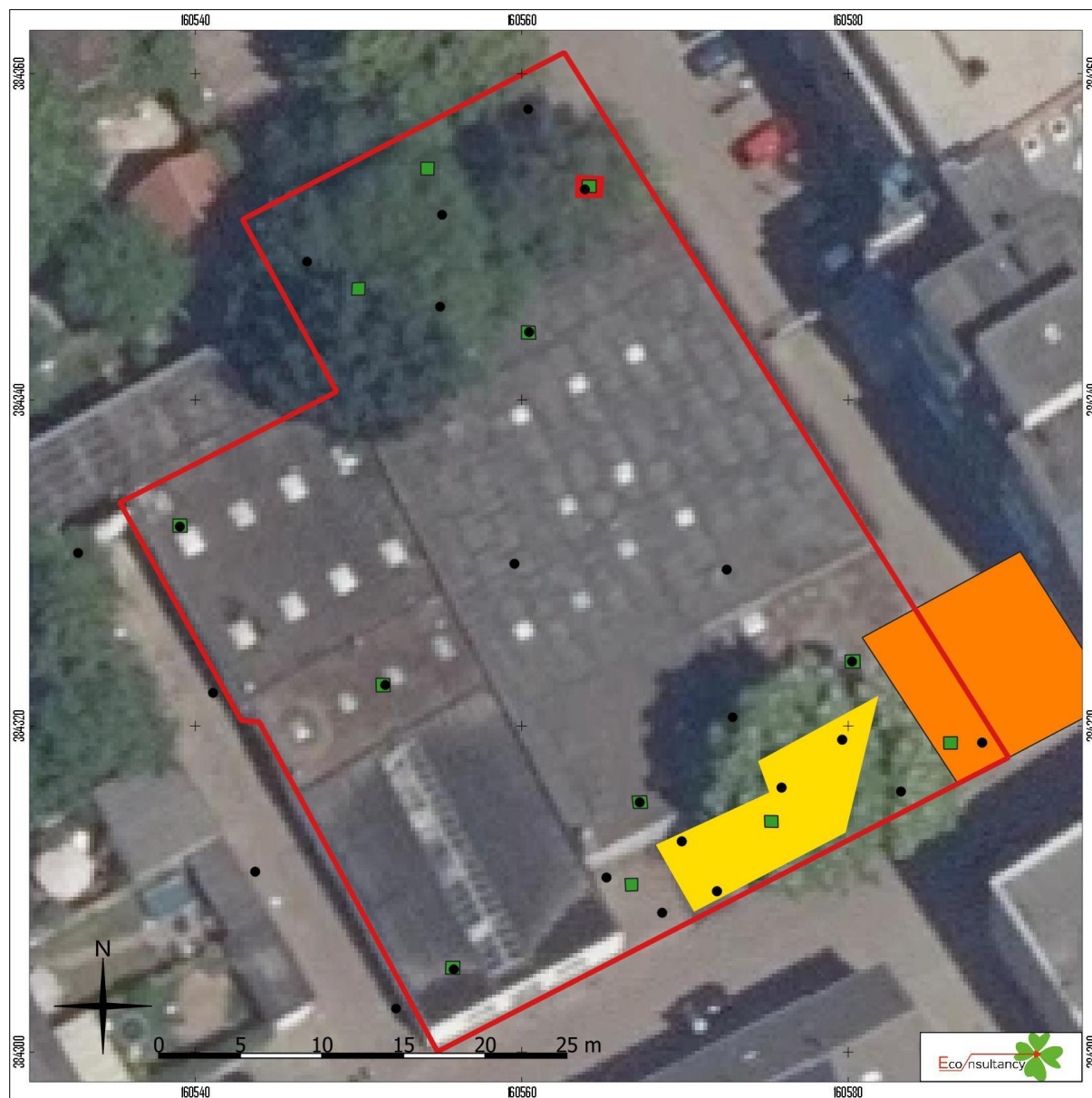
Figuur 6. Boorpuntenkaart met locaties bodemvervuiling en gesaneerde olietank
