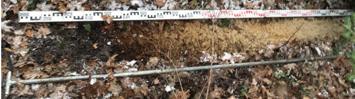
Afbeelding 8: Diepe profielboring in december 2022 in plangebied (onderzoekslocatie 2.3), waar tot een diepte tot 230 cm -mv is geboord. Hierbij is geen grondwater aangetroffen. De bodemopbouw in deze boring (humusrijk zand van 0-70 cm -mv, hieronder humusloos zand), is typerend voor het plangebied.
