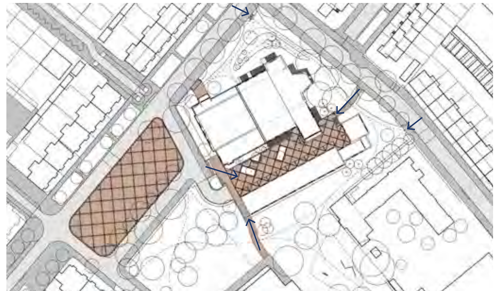
Totaalbeeld verharding met entrees
