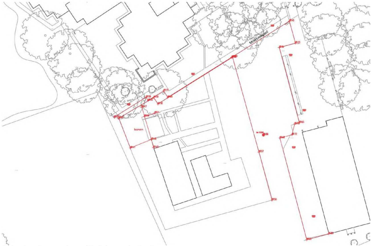
Nadere inmeting, geprojecteerd in de bestaande situatie
