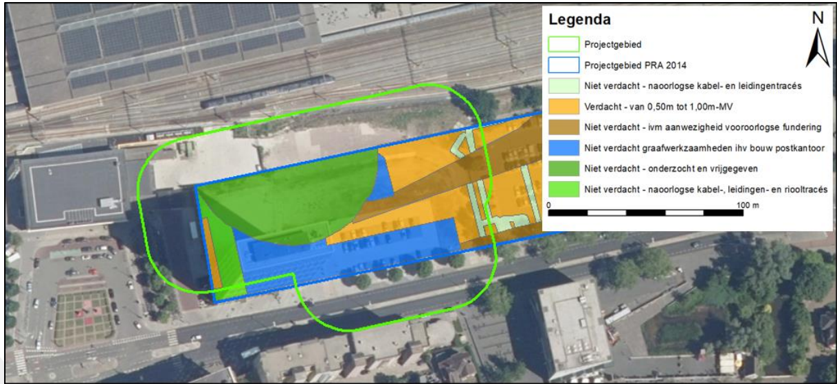
Figuur 3. Weergave van de samenhang tussen het uiteindelijke resultaat van de PRA (2014) en het huidige projectgebied. Hier is het geheel aan na oorlogse bodemroerende werkzaamheden en het resterende opsporingsgebied weergegeven. Bron satellietbeeld: World Imagery.
