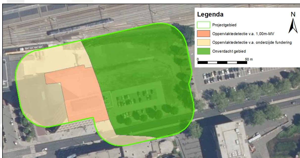
Figuur 20. het resterende verdachte gebied (opsporingsgebied), in mindering gebracht op basis van de diverse naoorlogse bodemroerende werkzaamheden. Bron satellietbeeld: World Imagery.
