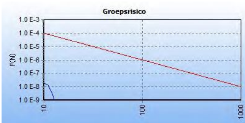
5.8 Figuur 5.8 FN curve voor Z-519-01 van N.V. Nederlandse Gasunie voor de kilometer tussen stationing 4100.00 en stationing 5100.00
