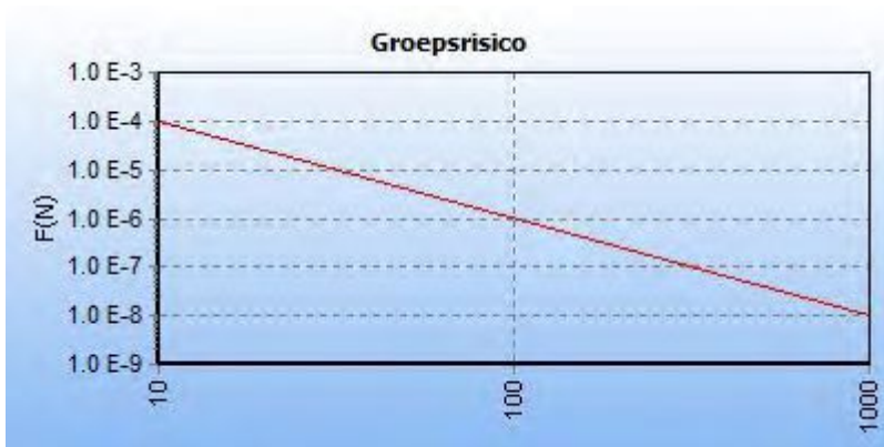
6.37. Figuur 5.11 FN curve voor Z-519-06 van N.V. Nederlandse Gasunie voor de kilometer tussen stationing 0.00 en stationing 750.00
