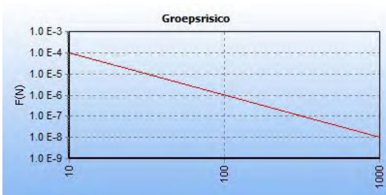
6.37. Figuur 5.11 FN curve voor Z-519-06 van N.V. Nederlandse Gasunie voor de kilometer tussen stationing 0.00 en stationing 750.00
