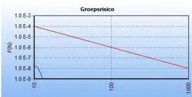
6.34. Figuur 5.8 FN curve voor Z-519-01 van N.V. Nederlandse Gasunie voor de kilometer tussen stationing 4100.00 en stationing 5100.00
