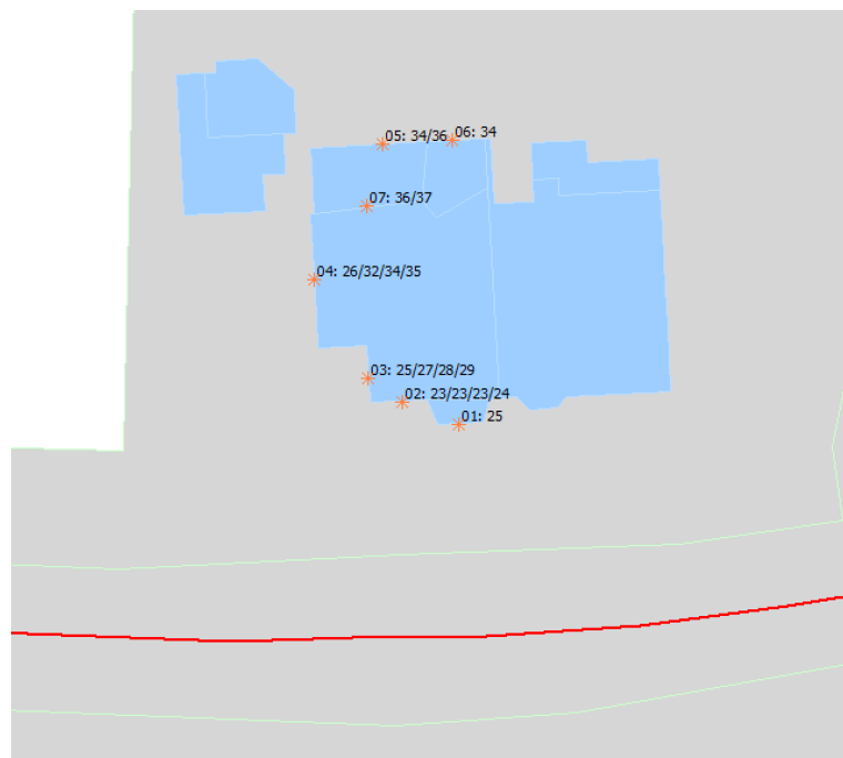
Figuur 4: Geluidbelasting in dB ten gevolge van de Futlaan.
