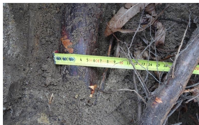
Afbeelding 11: wortel van 6 cm \varnothing op 28 cm beneden maaiveld.
