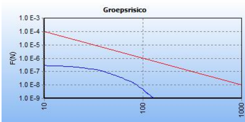
5.2 Figuur 5.2 FN curve voor 8198_leiding-Z-514-06-deel-1 van N.V. Nederlandse Gasunie voor de kilometer tussen stationing 4640.00 en stationing 5640.00
