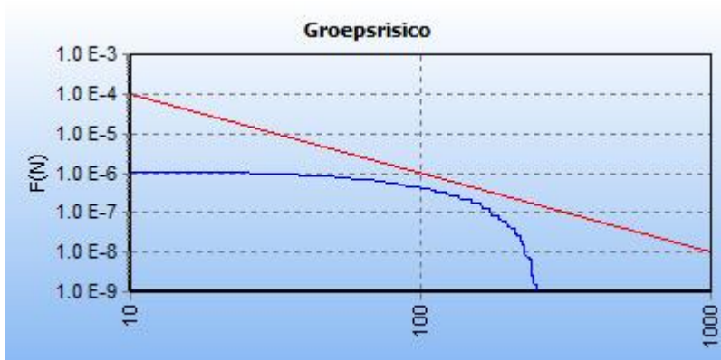
5.2 Figuur 5.2 FN curve voor 8198_leiding-Z-514-06-deel-1 van N.V. Nederlandse Gasunie voor de kilometer tussen stationing 4640.00 en stationing 5640.00
