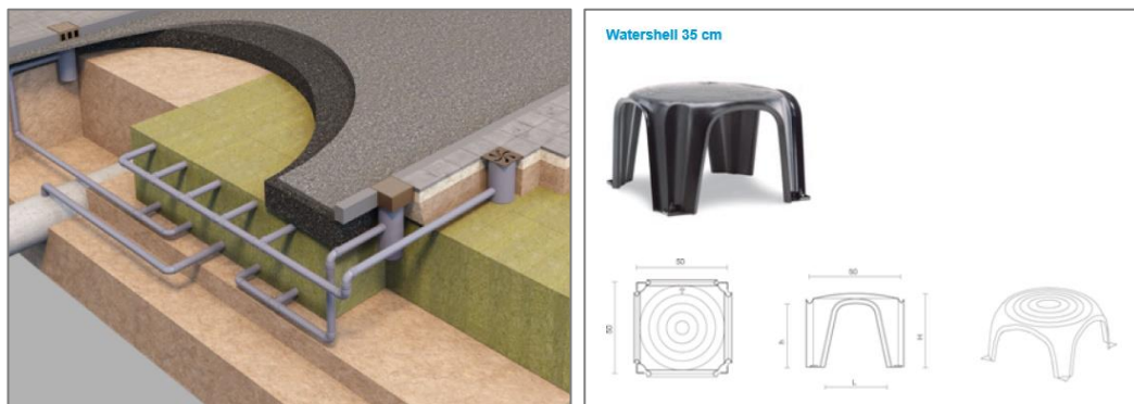
Figuur 6 Optie 1 Rockflow (links) en optie 2 Watershells (rechts)
