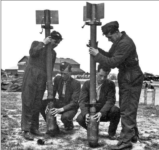
Britse SAP 60lbs lucht-gronddoel raketten werden gemonteerd onder de vleugel van Hawker Typhoon gevechtsvliegtuigen.
