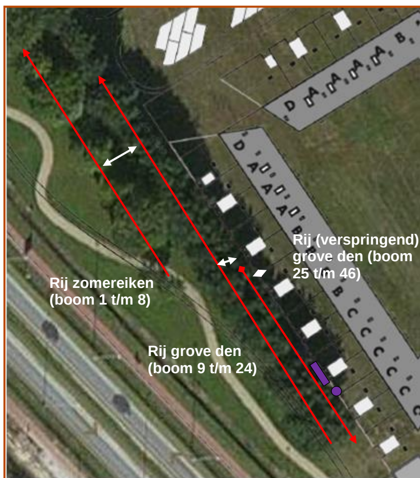
Afbeelding 16. In paars de grondboring en profielkuil op circa 2 meter uit de noordelijke rij grove dennen. De rode pijlen geven de rijen met bomen aan. De rijrichting is de richting van nummering. Tussen de rij zomereiken en 1 e rij grove dennen is 7 meter. Tussen de 2 rijen grove dennen 2 meter.
