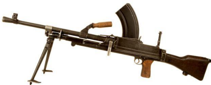
Afbeelding: Brits machinegeweer Bren MkII (kaliber .303)
