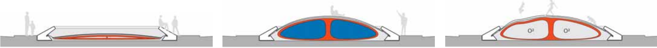
principe van de waterballon en de verschillende gebruiksmogelijkheden: leeg, gevuld met rioolwater, gevuld met lucht
