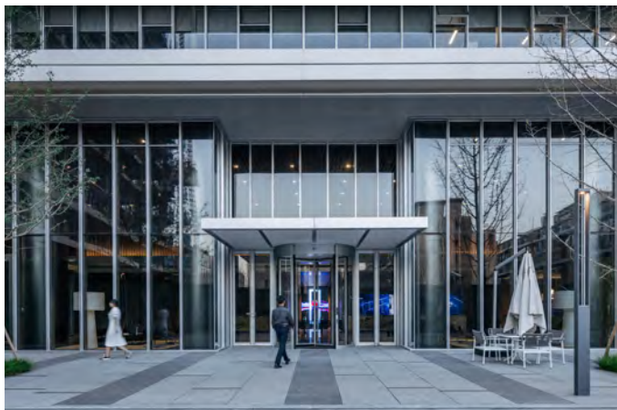
Entrees kunnen zichtbaar worden benadrukt door een opvallende aanpassing in de gevel, zoals een inspringing in de rooilijn.
