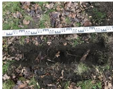
Afbeelding 14: wortel (ø 4 cm) op 10 cm-mv in profielkuil 3 bij boom 4.
