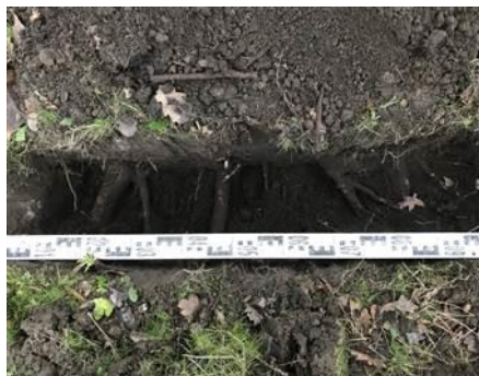
Afbeelding 13: intensieve beworteling in profielkuil 1 bij boom 13 vanaf 20 cm-mv.
