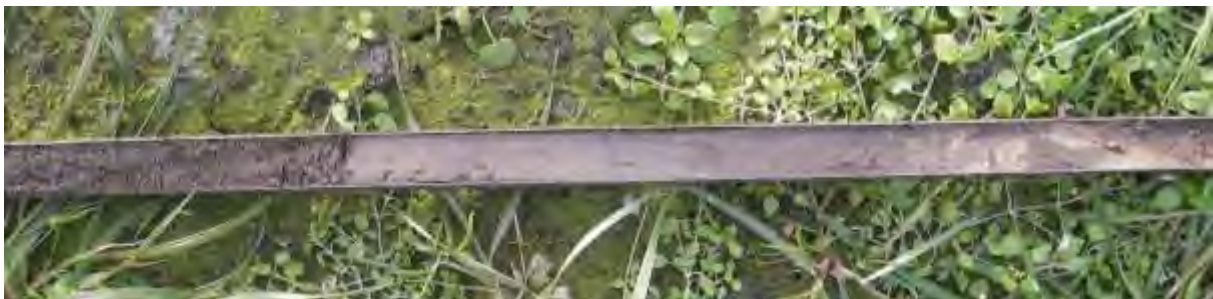
Figuur 18: Foto van het pakket zwak humeuze klei dat in de boringen 9 tot en met 12 is aangetroffen.
