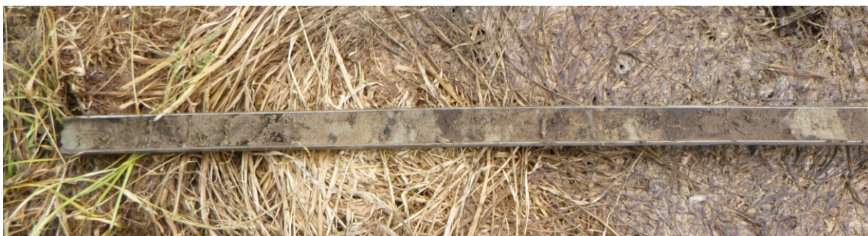
Figuur 20: Foto van het sterk vergraven zandpakket zoals dat op de boorpunten 1, 4, 5 en 6 doorloopt tot ongeveer een meter beneden het maaiveld. Geheel links is de grijze leem te zien.
