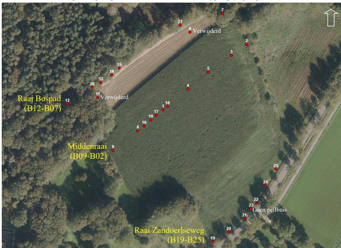
Figuur 5 Situering 3 raaien met diepe boringen en peilbuizen, verwijderde peilbuizen B06 en B11 en locatie boring B23 (geen peilbuis i.v.m. verband met nabijgelegen oprit perceel).
