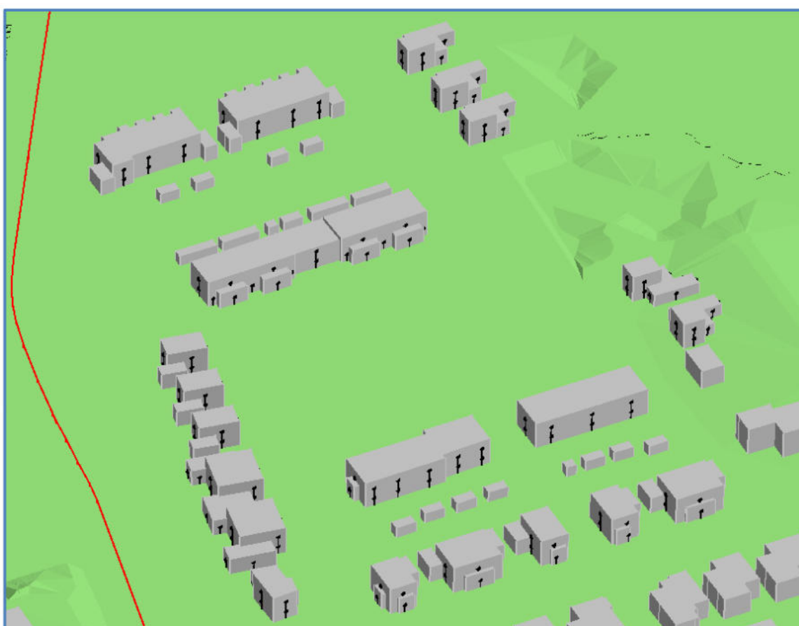
Afbeelding 6. Rekenmodel wegverkeerslawaai, 3d-weergave
