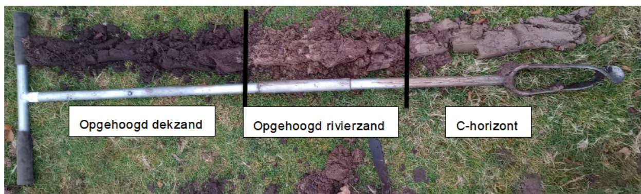
Figuur 15. Foto van boring 5.
