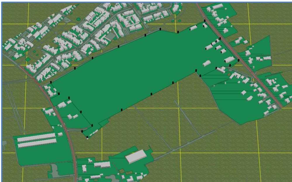
Afbelding 4. Rekenmodel wegverkeerslawaai, 3d-weergave
