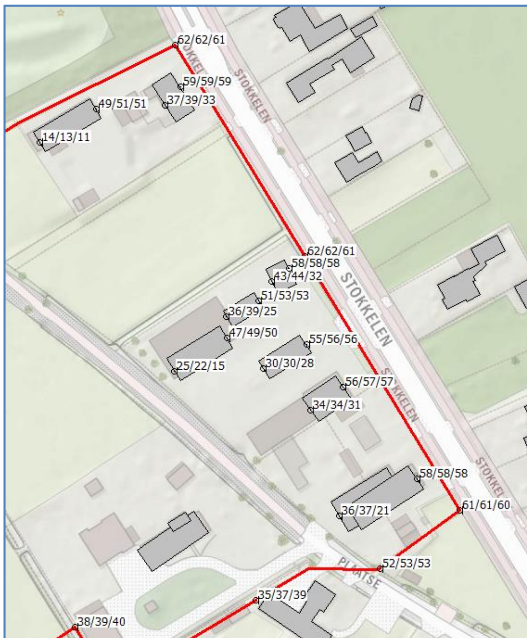
Afbeelding 6.2 Geluidbelastingen L_{den} Gemeentewegen + Gebouwen oost Berekende geluidbelastingen op een hoogte van 2,0 ; 5,0 (+Grid) en 8,0 meter
