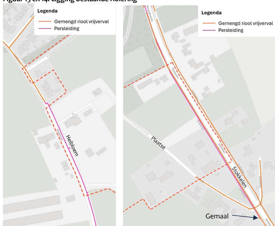
Figuur 13 en 14: Ligging bestaande riolering
