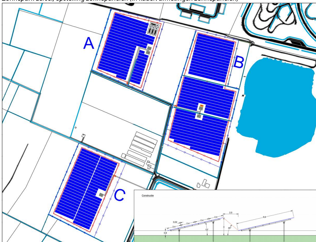
f2.2 Zonnepark Eersel, opstelling zonnepanelen (in kader: afmetingen zonnepanelen)
