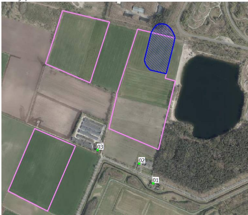
f3.4 Posities waar de maximale toename van de geluidbelasting van een helikopter van 1,0 dB(A) is berekend bij ontvangerpunt 02
