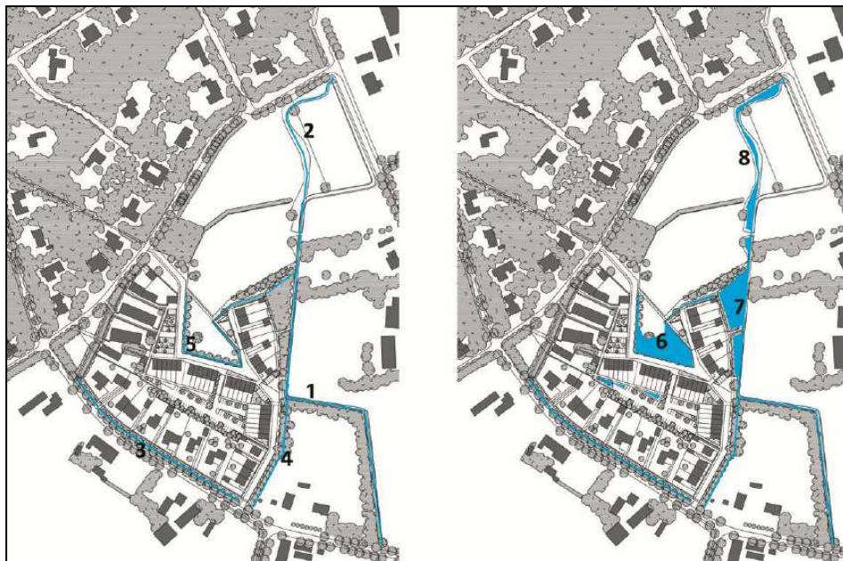
Figuur 35: Het watersysteem is duurzaam van opzet en bestaat uit zaksloten die zijn aangesloten op de Hazenloop (1). Deze Hazenloop krijgt een meer op natuur gericht verloop (2) in de landschappelijke zone. Aan de Mr de la Courtstraat is een zaksloot (3) voorzien, net als aansluitend op een bestaande kavelstoot (4) en centraal in het plan (5). Rechts de situatie na hevige regenval met een waterberging centraal in het plan (6), een bufferzone beplant met elzen achter de woningen (7) en een nieuwe slingerloop met natuurvriendelijke oevers (8) in het noordelijke deel van het plangebied.
