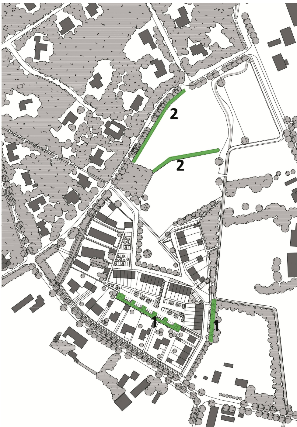
B3.6. Het plangebied wordt maar deels verstedelijkt; hier een weergave van de groensingels, bestaande uit gemengde singels aan de zuidzijde (1) en struikensingels (2) in de landschapszone aan de noordzijde.
