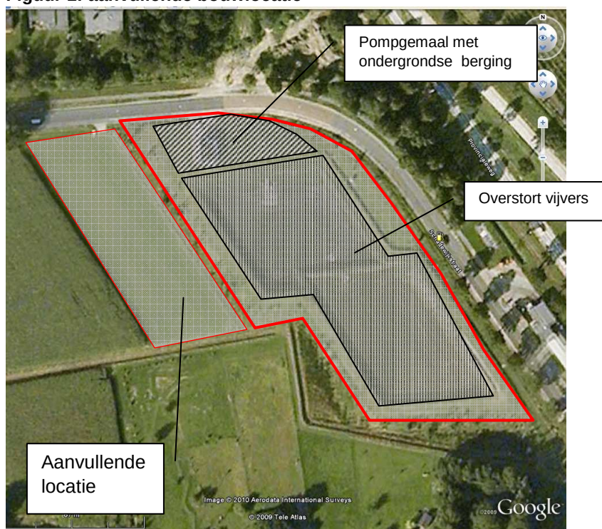
Figuur 1: aanvullende bouwlocatie
