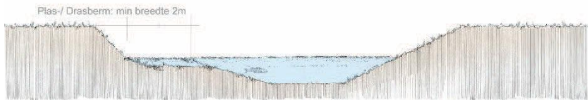
Principevoorbeeld enkelzijdige plas-drasberm. (Uit handreiking NVO, Stowa, 2009)
