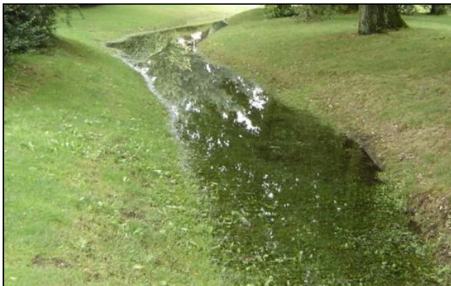
Figuur 16: Voorbeelden infiltratievoorzieningen op maaiveld niveau
