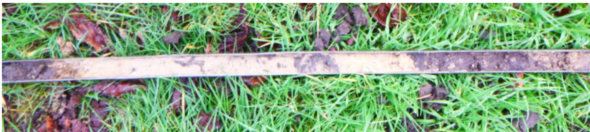
Figuur 21: Foto van het sterk vergraven zandpakket zoals dat op de meeste boorpunten vanaf het maaiveld is aangetroffen.
