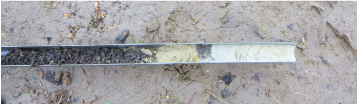
Figuur 22: Foto van het moerige zand (links) zoals dit in de boringen 7, 8, 11, 15, 16, 18 en 19 is aangetroffen (in dit geval in boring 18). Rechts is het grijze, lemige zand van de C-horizont te zien.
