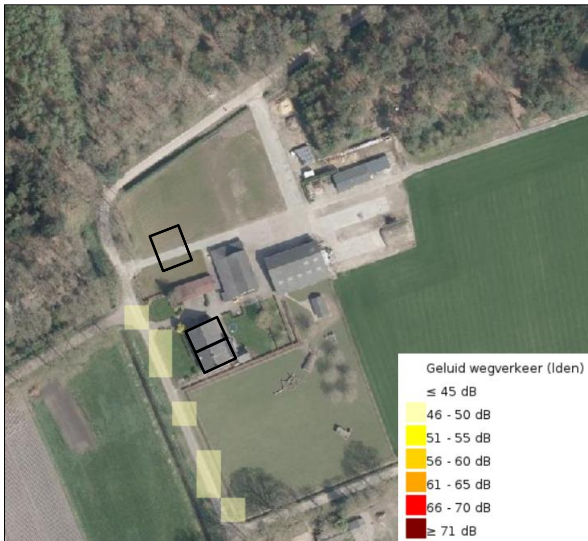
Afbeelding 10 Geluidsbelasting op geprojecteerde woningen (beoogde woningen zijn indicatief aangegeven met zwarte omlijning)
