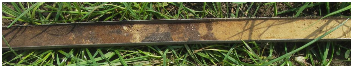
Figuur 19: Foto van boring 13 met links met brokken schoon geel zand vermengd humusrijk zand, in het midden met brokken humusrijk zand vermengd schoon geel zand en rechts de onverstoorte C-horizont.
