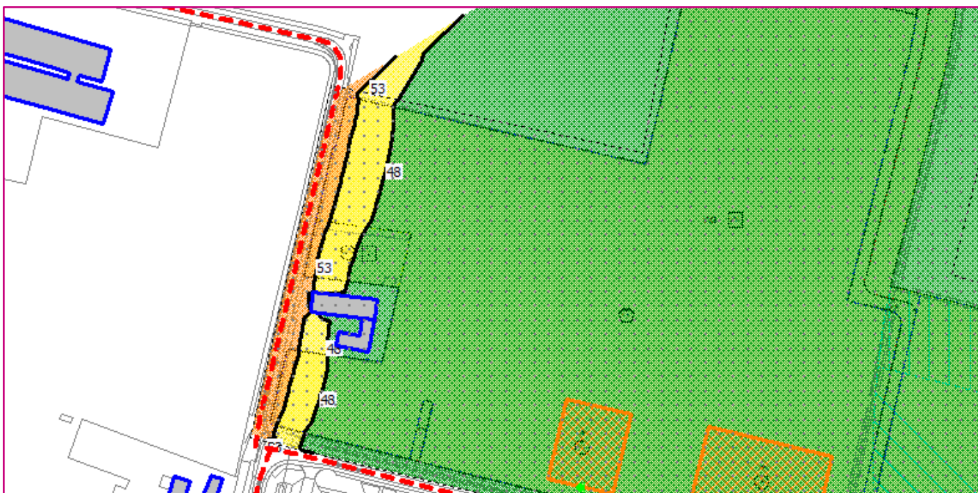
Figuur 5.3 Geluidcontouren Laagstraat, toets hoogte 8 meter
