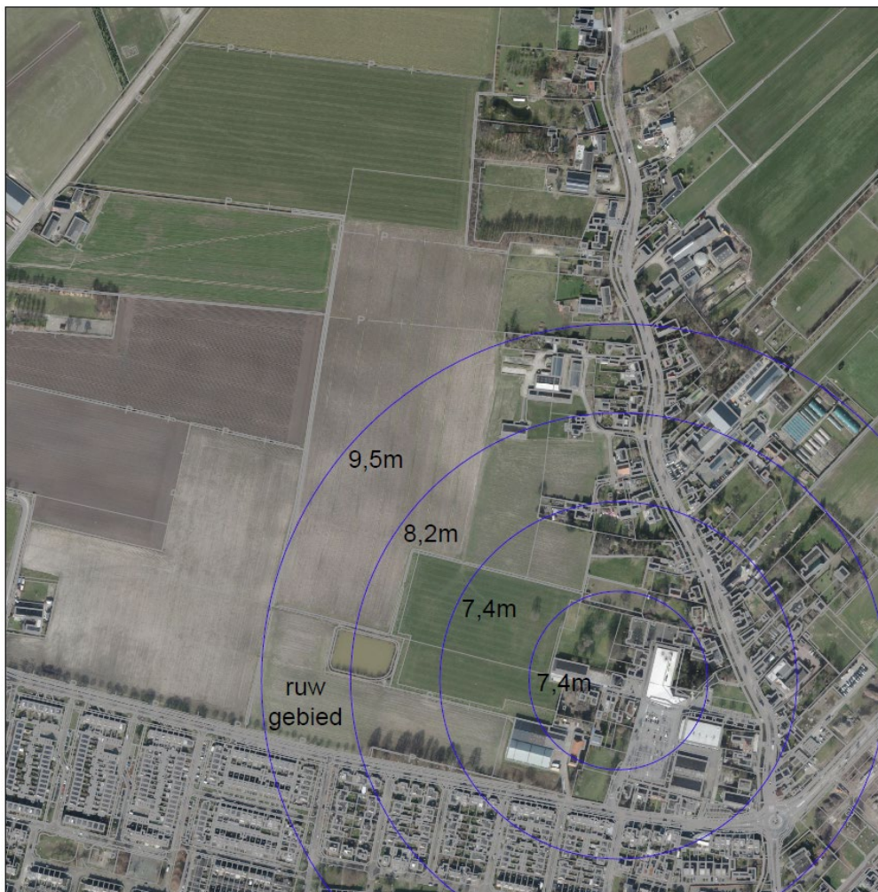
Figuur 1 Richthoogten voor bebouwing en beplanting afgezet tegen afstand van de molen met hantering constante voor een ruw gebied
