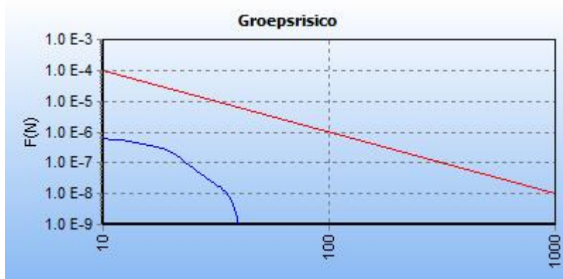
5.1 Figuur 5.1 FN curve voor 7106_leiding-A-531-deel-1 van N.V. Nederlandse Gasunie voor de kilometer tussen stationing 1510.00 en stationing 2510.00
