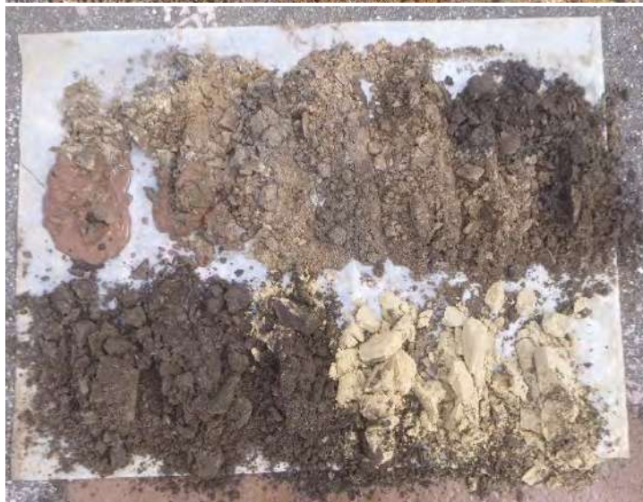
Fig. 3. Dongen – Eindsestraat. Bodemopbouw onder de verharding in het centrale deel. Boven: boring 35 met restant van de Bs-horizont in de top van het dekzand. Onder: boring 26 met geroerd pakket dat direct overgaat in de C-horizont in het dekzand.
