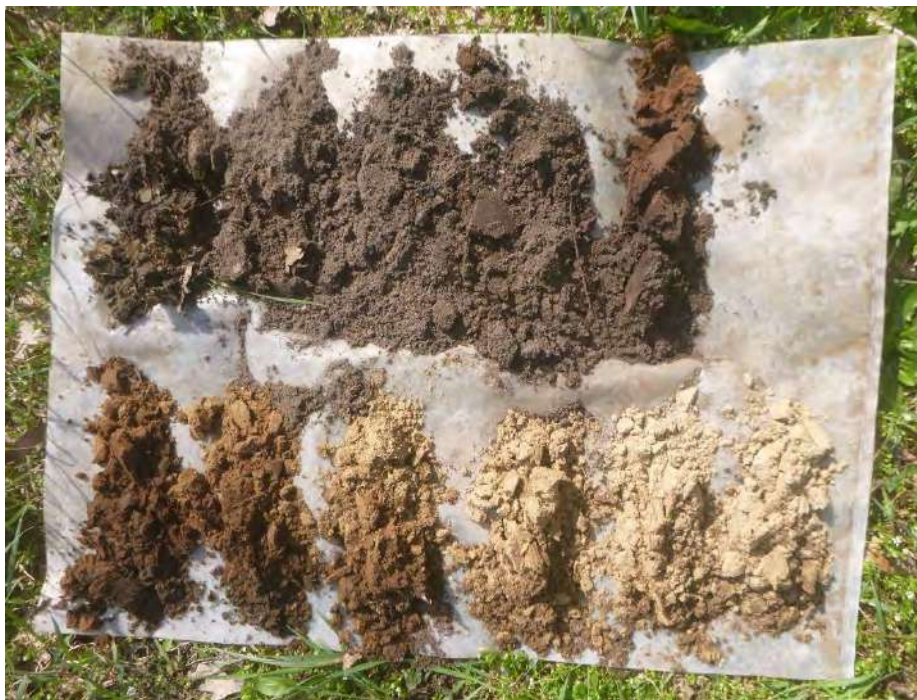
Fig. 1. Dongen – Eindsestraat. Boring 10 met Bs-horizont in de top van het dekzand.
