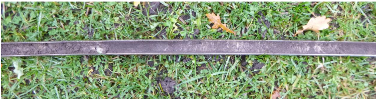
Figuur 24: Foto van de met geel zand vermengde massa van brokken zand van wisselend humusgehalte zoals deze op alle boorpunten is aangetroffen.
