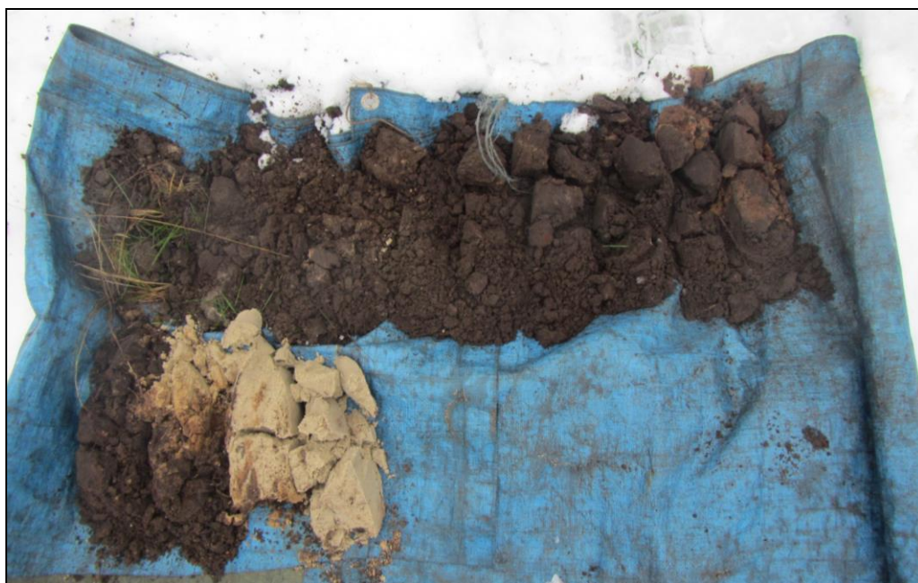
Figuur 7: Zicht op boring 5 uitgelegd van linksboven naar rechtsonder (0-150 cm –mv).
