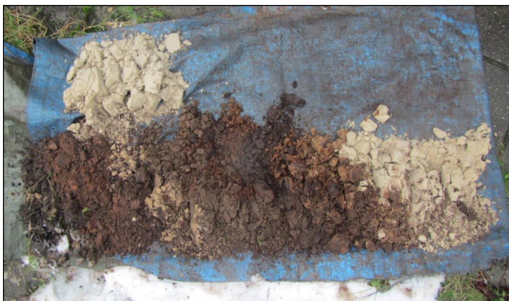
Figuur 8: Zicht op boring 1 uitgelegd van linksboven naar rechtsonder (0-150 cm –mv).
