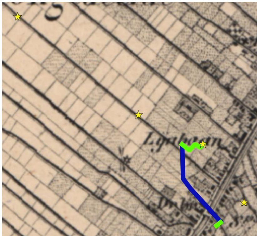
1900 met groen: open ontgraving, donker blauw: HDD-gestuurde boring, ster: afsluiterschema.
