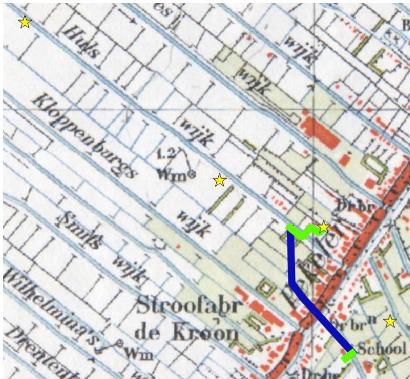
1943 met groen: open ontgraving, donker blauw: HDD-gestuurde boring, ster: afsluiterschema.
