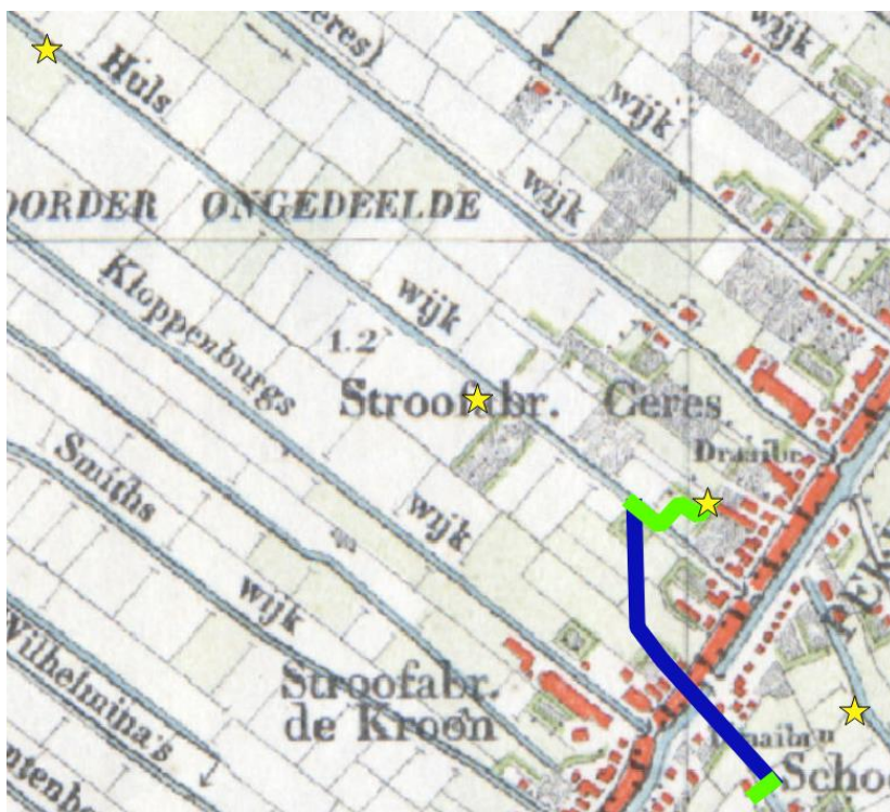
1925 met groen: open ontgraving, donker blauw: HDD-gestuurde boring, ster: afsluiterschema.
