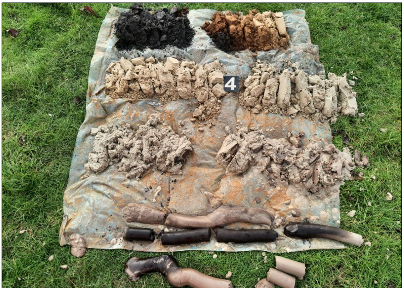
Afbeelding 7: Foto boorprofiel boring 04; leesrichting van linksboven naar rechtsonder per 0,5 meter uitgelegd.
